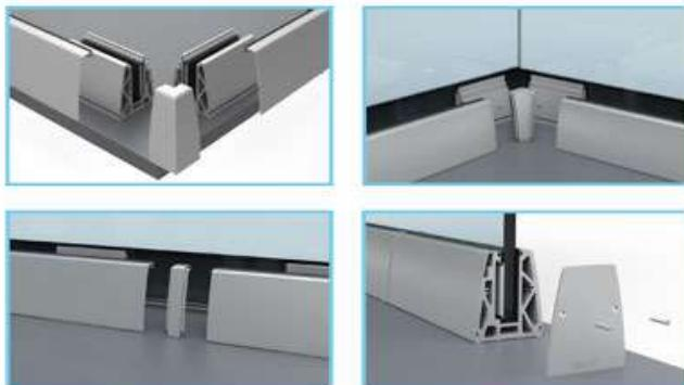
**C** 150 mm ve 300 mm parçalar halinde kullanılır. Taşıyıcı bazalar arasında kalan boşluklar max. 300 mm olmalıdır. Oval kapaklı sistemlerde köşe ve ekleme aparatları ile hem montaj kolaylığı sağlar hem de ısı farklarından oluşabilecek genleşmelerden kaynaklanan derz hareketlerini bertaraf etmek için çözüm sunar.
