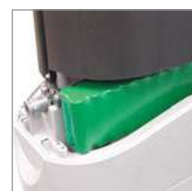
Back up battery. Batterie de réserve.
